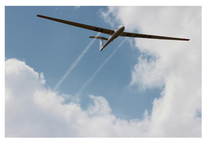
Segelflugzeug (hier ein Standard Cirrus) beim Zielüberflug nach einem Streckenflug. Die weissen Streifen sind Wasser, das der Pilot ablässt dessen Gewicht bei gutem Wetter hilft, das Flugzeug schneller fliegen zu können.
